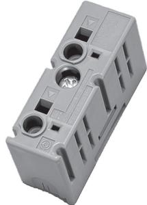
不二電機工業の専用分電盤なめ作業がはたため、配線を差し込める省施工に貢献する電線接続表示(インジケータ)付きアース速結端子台「TPG形」は、ねじ締め作業が約4分の1に短縮できる。このため、アース配線の作業時間が約4分の1に、プスパーへの取り付け時間の約3分の1に短縮できる。また、ねじ締め作業も不要で、ねじ締め作業の管理や専用工具管理もなくなる。また、電線接続状態の表示(インジケータ)は、電線が確実に接続されたことを確認できる。400sqまで対応可能。
