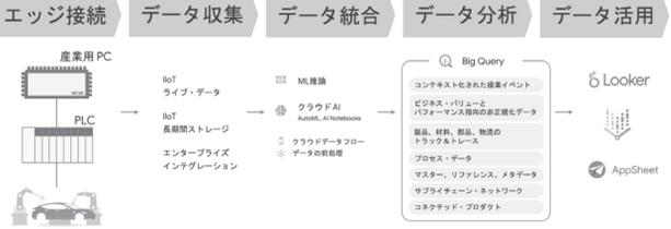
図2: クラウドサービスが提供する工場IoTデータ活用基盤の例
