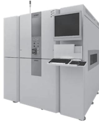
接合面積は電流容量、電圧容量に関連する重要な要素で、不十分だと性能が十分に発揮できなくなります。例えばEVでは放電の時間が倍かかるとなったり、走行距離が短くなったりする原因になります。またはんだの中に気泡があると発熱の原因になり、発熱を防ぐために性能を落とさなければならなかったり、耐久性が犠牲になって故障の原因になったりもします。そうしたものを検査で見つけ出すことができます。
