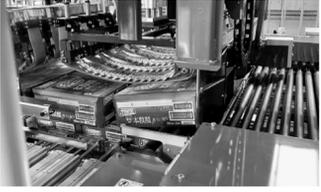
新たな自動ラックでは、ラック内で荷物の搬送を行うクレーンと出入庫ステーションを更新し、出入庫能力を増強。出入庫口数の増設と出庫スピードを従来比の約2倍に向上させ、14分/台の待ち時間を削減する予定。従来の自動ラックに比べ、倉庫の収容能力は3.3倍に向上させた。
