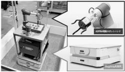
協働ロボット向け「ASPINA電動ロボットハンド」を搭載した、自走ロボットアーム(モバイルマニピュレータ)型AMRのデモンストレーションを行い、製造現場での具体的な使用イメージを展示を行う。ロボットアームとハンドが「手」、AMRが「脚」の役割を担い、搬送物の受け取り、移動しながら作業、搬送先での受け渡しまでを自律的に行うことができる。
