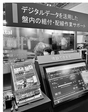
に表示される3Dレイアウト図での配線経路を見ながら作業指示通りに制御盤の配線を行う体験デモを実施。考えたり、迷ったりすることなくスムーズに作業ができ、作業体験をした人や周りで見ていた人からは「画面の通りにやればよかったから確かに簡
