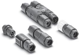
IPDシリーズは、Push-in式を改良したPush-lock式を採用しており、迅速な接続に加え、裸線の接続や電線の取り外しを容易にすることで、より柔軟な配線に対応。QPDシリーズは、電線を固定したナットを締め込むことで、高い信頼性と耐久性を確保する圧接式を採用している。いずれのシリーズも、作業性や生産性に優れており、IP69Kという最高グレードの保護等級を有するため、過酷な環境下での使用にも適しており、装置や設備だけでなく、トンネルやインフラ、イントラロジスティクスなどの広い分野にも使用されている。
