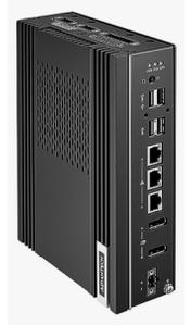
NVIDIA RTX技術に対応したMXM GPUモジュールをサポートする拡張キャリアと組み合わせることで、AIアプリケーションの推論能力を大幅に強化でき、SKY-MXM-2000AやSKY-MXM-A1000などのMXM GPUモジュールを搭載可能。リアルタイムデータ処理や画像解析に最適な4つの独立ディスプレイ出力を提供し、冷却性能を向上させるヒートシンクとファンも備えている。工場のプロセス制御や画像データ解析、空港や交通インフラなどにも最適。特にリアルタイムデータの可視化や複数ディスプレイでの情報表示が必要な環境に適している。
