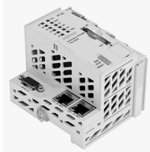
「PFC300」は、2GB RAM、64ビットのデュアルコアCPUを搭載し、高い処理能力で大きく高度な要求にも対応できるPLC。Linux OS上でIEC61131-1に準拠したプログラミング、CODESYS V3.5でプログラムができ、WAGO I/O Systemのモジュールを接続できる。2つのEthernetポートはスイッチ機能を内蔵し、ダイジーチェーン接続が可能。内蔵のWEBサーバ機能により、PFC300のステータス情報の表示やユーザー設定もできる。
