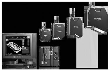
レーザー光源を内蔵し、単波長に特化した光学系のため、照明条件の調整が要らず、工場の天井照明などの外乱光の影響も受けずに安定した検査が可能。
