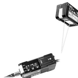
静止分解能0.5μm、リニアリティ0.025%F.S.、温度特性0.01%F.S./°Cのクラス最高レベルの検出性能と、初期設定のまま安定検出できる高いセンシング性能を実現。同一設定でさまざまな材質の検出ができ、高さ測定、傾き検出、位置決めなど10μm~1mm程度の判別用途に幅広く対応し、光が返って来にくい車体の塗装面のような黒光沢ワークから、プリント基板、黒ゴム、光が多く返ってくるステンレスのような金属ワークまで同じ設定で安定検出。ワークごとに必要だった測定周期の調整を不要とした。設置自由度も高く、斜め設置をしなければならない場合でも広い角度特性で約85度まで測定でき、柔軟な設置に対応。
