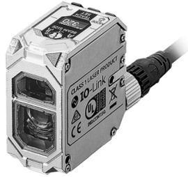
光が飛んで戻ってくる「時間」を計測して距離情報に変換するため、ワークの表面状態に関係なく有無検出が可能。レーザー1クラスの制限の中でぎりぎりまで投光パワーを高め、従来素子の数十倍の高感度受光素子を採用したことで、検出精度は5cmから6mまで、角度特性も最大±85度の広さを実現。設定した距離と範囲にあるワークのみを検知するため、センサとワークの間に人や物が介在しても反応せず、誤検知を防止。そのため設置自由度が非常に高く、従来はNGとされていたワークやコンベアから離れた場所へのセンサ設置も可能。柔軟かつ自由な装置・ラインを作ることができる。筐体はクロムメッキ処理を施したアルミダイカスト製で、軽量ながら衝撃や環境変化に強く、検出面は防汚コーティングで汚れや曇りを防止。さらにセンサが正常に稼働しているかが一目で分かるように底面に表示灯を搭載。日本語、英語、スペイン語、イタリア語、ドイツ語の5か国語の表示に対応するなど使いやすさも向上している。
