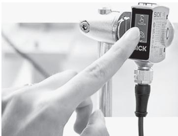
高精度クラス1レーザ光源と、高速かつ高精度なライン受光素子を組み合わせ、20~400mmのショートレンジ、20~700mmのロングレンジバージョン共に、高い繰り返し精度で非常に正確な検出を実現。スピードモードでの応答時間は1.5ms。高速稼働する機械でも信頼性の高いスイッチング出力を保証している。最適な調整を行うための個別ティーンオプションを用意し、設定された距離の対象物を検出する通常の1ポイントティーンに加え、2ポイントティーンでは異なる距離の対象物を検出。マニュアルモードはティーンオプションを拡張し、さらに柔軟に使うことができる。
