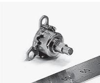
同製品は、モータと変速機など2つの動力伝達軸の間に使用し、入力軸からの回転(トルク)を出力軸に伝達し、出力軸からの回転(トルク)は入力軸に伝達しない逆入力遮断クラッチ。同様の機能を持つ電磁ブレーキと比べて、電気や配線が不要となるため、搭載機器の省エネルギー化が可能となり、停電時における安全性にも優れている。
