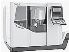
スカイビング、ホブ、旋削、穴あけなど歯車加工工程を1台に集約。外径φ100mm、全長300mmまでの小型ワークに最適。最適な軸構成と特殊加工ツール、プログラムで旋削機能を強化した。旋削、穴あけ、歯切り加工機のライン構成と比較し、設置面積を54%減らしている。高剛性本体と多軸同時制御で自由曲面の高精度加工も可能だ。
